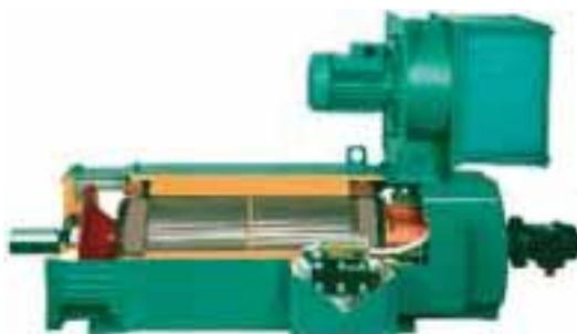
↑ Рис. 17 Двигатель постоянного тока
