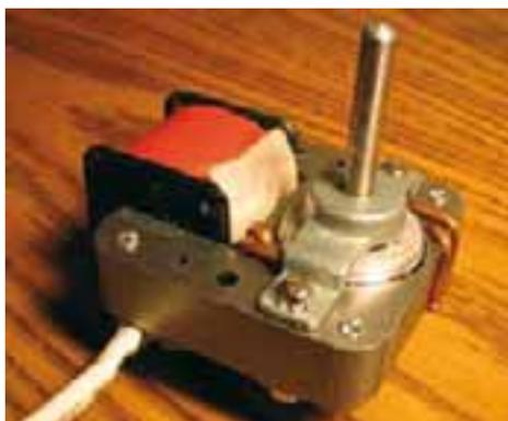
↑ Рис. 10 Однофазный двигатель с короткозамкнутыми фазосдвигающими кольцами
