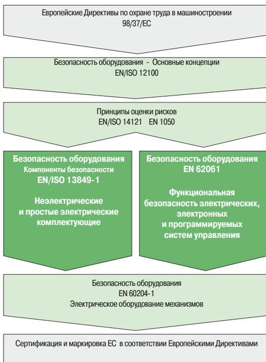
↑ Рис. 6 Стандарты, применяемые при проектировании механизмов
