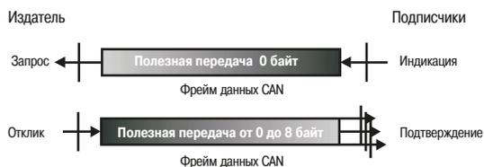
↑ Рис. 19 Модель CAN «издатель/подписчик» (выталкивание / вталкивание данных)
